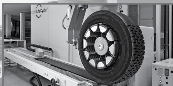
Construction d'un ContiTread™
